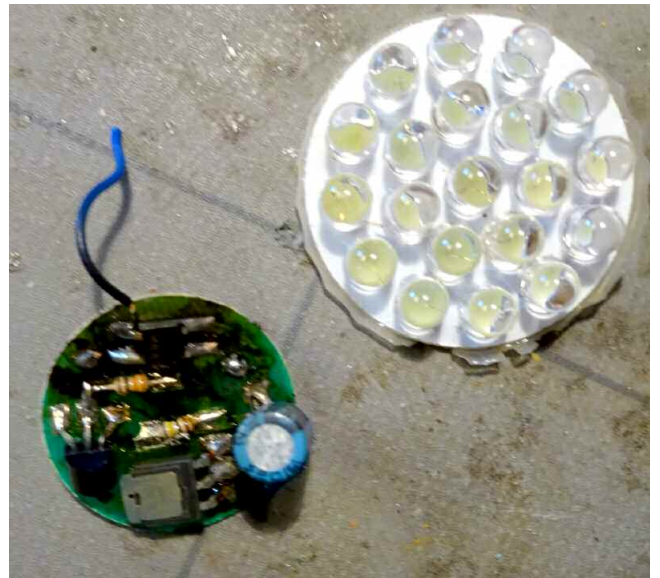
De witte ronde printplaat met 20 stuks LED's is losgesoldeerd van de groene componenten printplaat.
