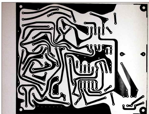
Fig. 7b - De kopij van fig. 7a van de stereo-versterker. De in dit artikel vermelde geïntegreerde versterkers zijn bij de SEK (Selekt Elektronika Kring-)dealers te koop. De prijs zal ongeveer op 13,- komen per IC.
